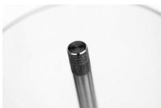
Il serbatoio viene fornito con la **valvola di regolazione del gocciolio** separata: per il montaggio è sufficiente inserire l'asta metallica all'interno della sede centrale del perno e avvitare in senso orario. Allo stesso modo è possibile regolare il flusso del gocciolio: per limitare avvitare in senso orario e per aumentare svitare in senso anti-orario.
